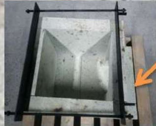
④押さえ金具を取り付ける。2人で行うと簡単です。
