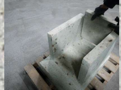
2 縦板・裏板を組む
